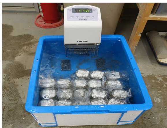
写真-1 温水養生の様子
